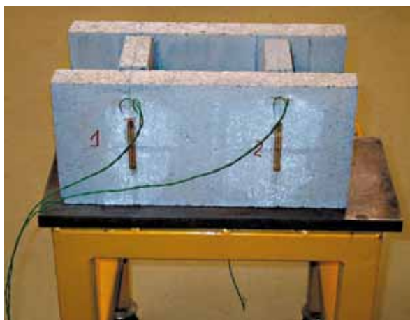
Fig.10 Elemento predisposto con Strain Gauge per la determinazione della funzione \sigma = f(\epsilon) . I dati vengono rilevati da specifiche apparecchiature elettroniche, asservite a computer, che con un programma di "regressione matematica" di tipo esponenziale esprime la funzione in termini analitici, funzione necessaria per il calcolo flessionale della strutturazione allo stato limite ultimo.
