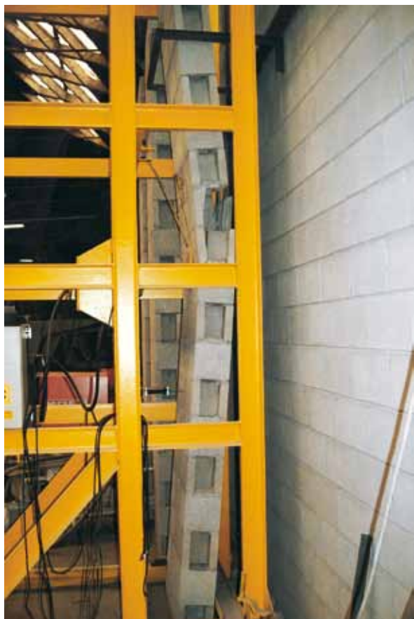
Fig. 15a Prova a flessione di una strutturazione nei Laboratori Vibrapac (di dette prove si dispone di certificati ICITE).
