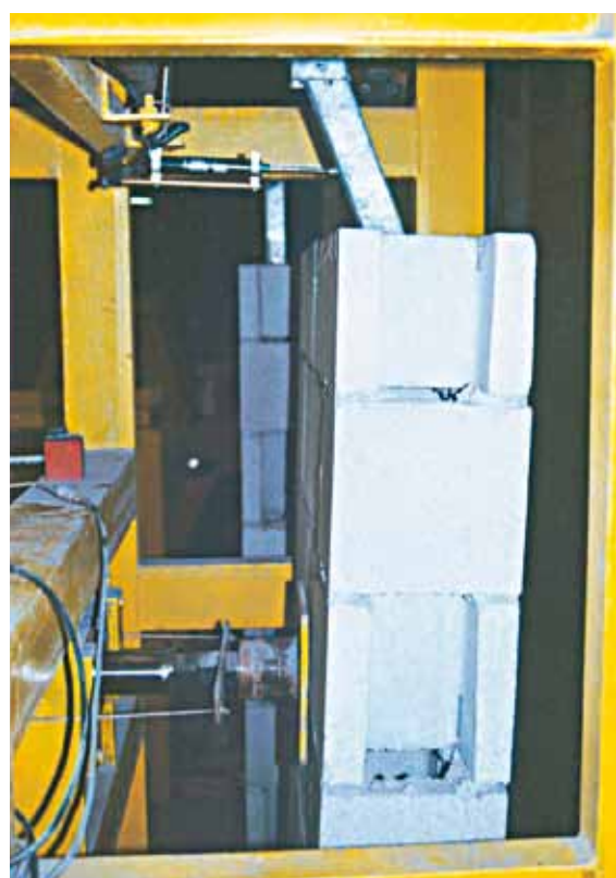
Fig. 17 Prova sperimentale di resistenza di una staffa di sommità.
