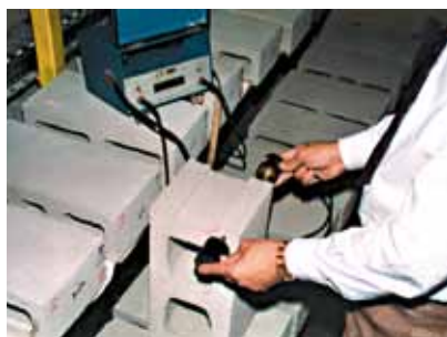
Fig. 5 PROVE DI LABORATORIO Controllo di porosità del cls
