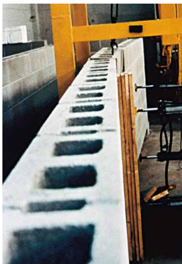
Fig. 15a Prova a flessione di una strutturazione nei Laboratori Vibrapac (di dette prove si dispone di certificati ICITE).
